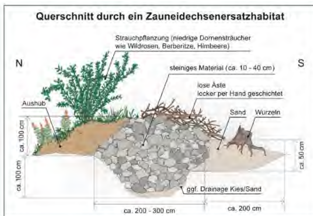
Abb. 8: Prinzpskizze eines Ersatzhabitats mit Überwinterungsmöglichkeit, Totholz und Exablage substrat. Grafik: LfU nach einer Vorlage von Irene Wisgensegger, akt. 2020
